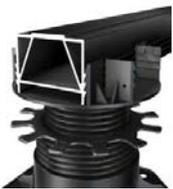
Grundsätzlich gilt, dass Stützschiene nicht an der Dachoberfläche befestigt werden können und Höhenunterschiede ausgeglichen werden müssen. Die beste Lösung: Ein festes Rahmenwerk mit Querstreben aus Alu Support Rail Large in Kombination mit UPM ProFi Foot und/oder UPM ProFi Rubber Pad. Der maximale Abstand von Querstreben darf nicht größer als 2 m sein (von Mitte zu Mitte).
